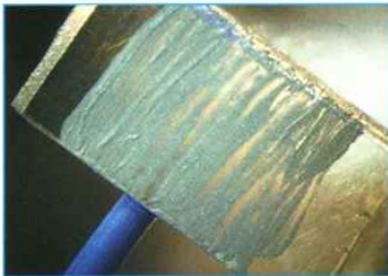
Abb. 10: Rautiefe 4 bis 7 \mu\text{m} , Schichtstärke 0 bis 10 \mu\text{m}
